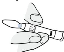
4.3. Slå uåpnet ampuller flere ganger mot en hard overflate, for eksempel en bordplate. Ved å gjøre dette vil partikler som ligger ved innsiden av ampulleveggene falle nedover.
