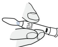
4.3. Tapoter plusieurs fois l'ampoule fermée sur une surface plane (par ex. une table). Les précipités formés sur la paroi de l'ampoule tombent de cette manière vers le fond.
