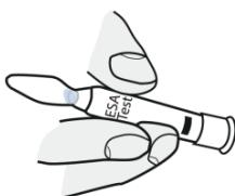
4.3. Bank uåbnede ampuller flere gange mod en hård overflade, såsom en bordplade. Ved at gøre dette, partikler placeret på indersiden af patronen væg falder ned ad.
