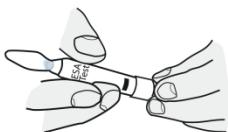
4.4. Ouvrir l'ampoule comme suit: Tenir le corps de l'ampoule (partie inférieure) fermement dans la main. Maintenir le bout de l'ampoule (partie supérieure) entre le pouce et l'index de l'autre main et rompre
