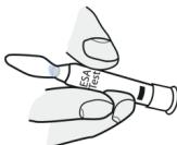
4.3. Bata a ampola fechada várias vezes contra uma superfície dura, como uma mesa. Ao fazer isso, as partículas que podem estar agarradas ao interior da parede da ampola irão cair.
