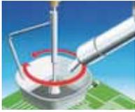
Entlöten des IC-Bauteils mit Heißluft
